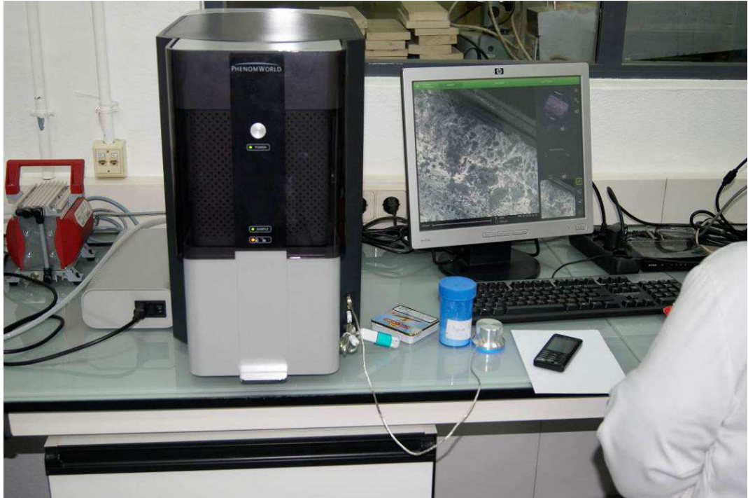
Figura 16.- Equipo de microscopía electrónica de barrido SEM
