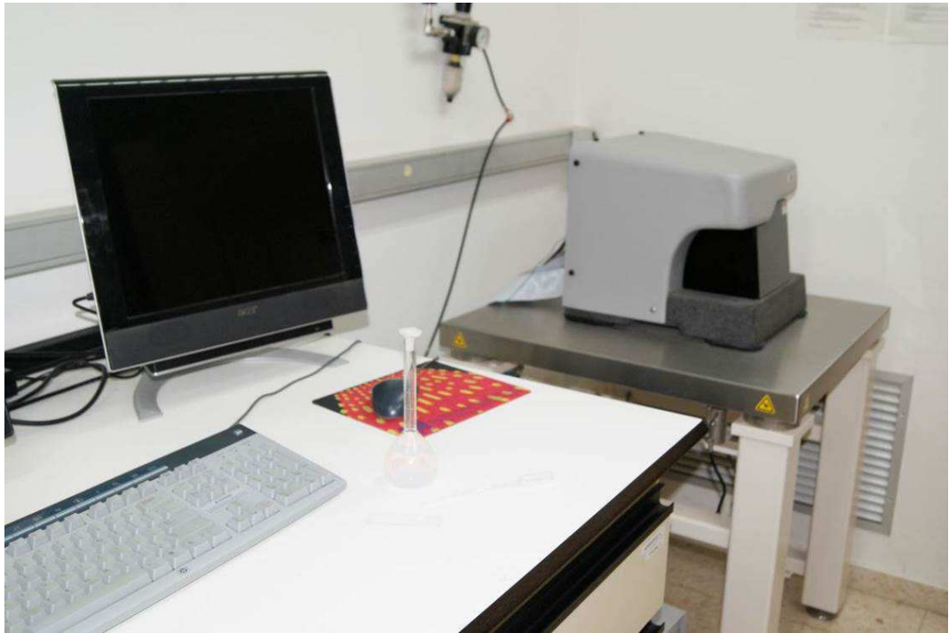
Figura 1.- Microscopia de Fuerza Atómica, para observación de nanopartículas de \text{TiO}_2 ref. Aldrich
