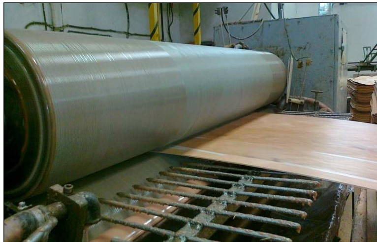
Figura 5.- Encoladora de tableros (Tableros Vicente Folgado)
