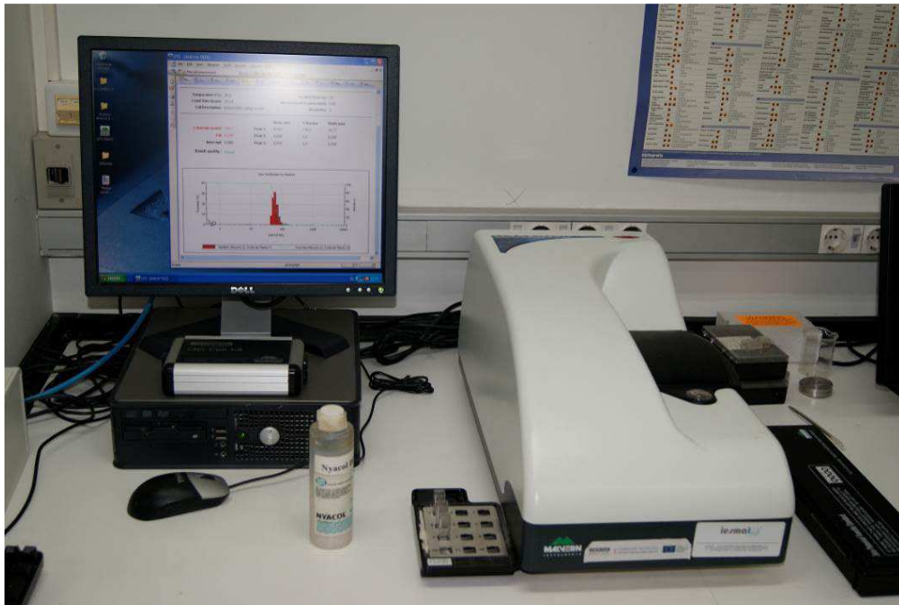
Figura 11- Equipo de medición de tamaños de partícula por DLS
