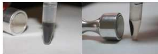
© AIDIMA - Separación magnética de nanocompuestos para su reutilización en la depuración de aguas residuales.
