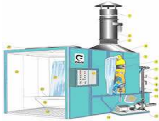
Figura 7.- Esquema de una cabina de pintura con cortina de agua
